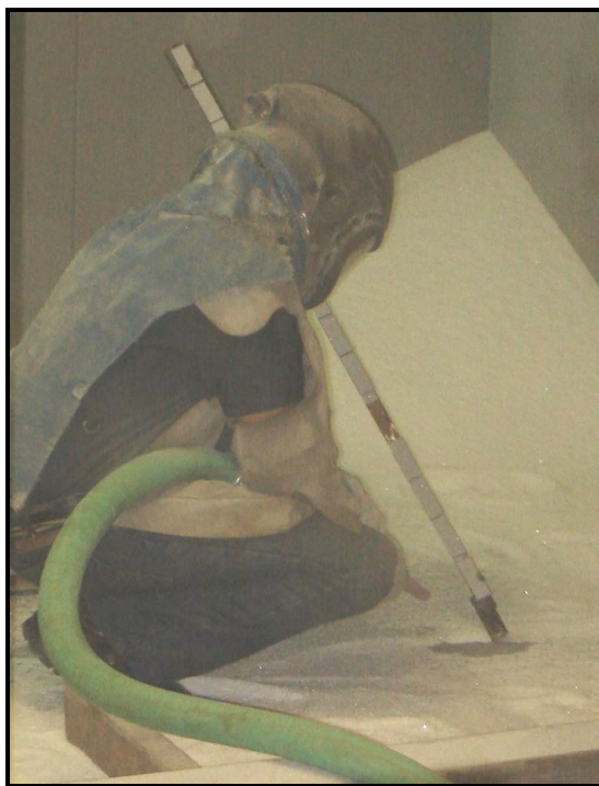
Figura 3.4 Proceso de arenado con alúmina \text{Al}_2\text{O}_3 .
