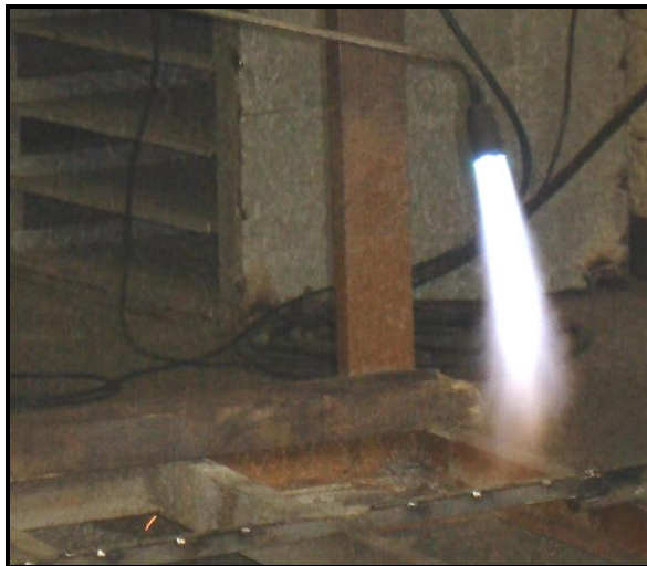
Figura 3.3 Precalentamiento de las probetas con llama oxiacetilénica.
