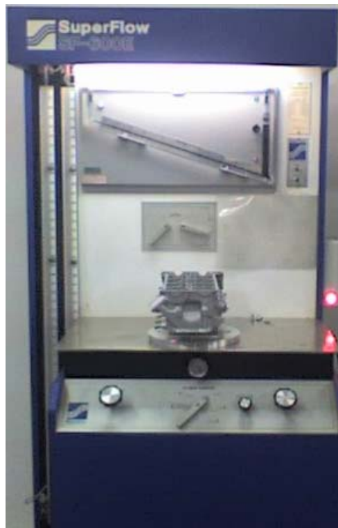
Figura 4.2 : Banco di flussaggio con testa motore
