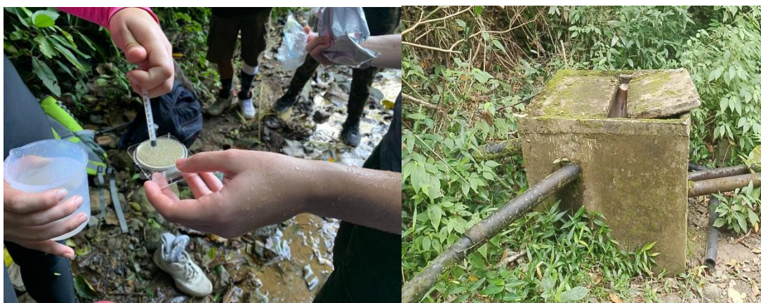
Figura 14 Medición de indicadores bacteriológicos Escherichia coli en campo. (Izquierda) Purificador de agua ubicado a las afueras de la comunidad las aguadas. Coordenadas UTM zona 19N 726350 mE 1168131,9 mN (Derecha)
