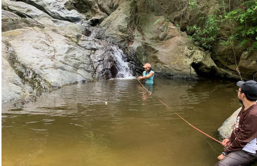
Figura 9 Medición de la Velocidad de un Cauce en la Cuenca Miguelena, ubicado en el Estado la Guaira, Venezuela.
