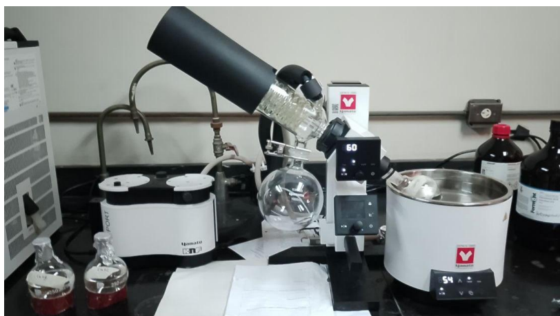
Figura 19 Rotoevaporación de la muestra en el equipo modelo REV202M-A.
