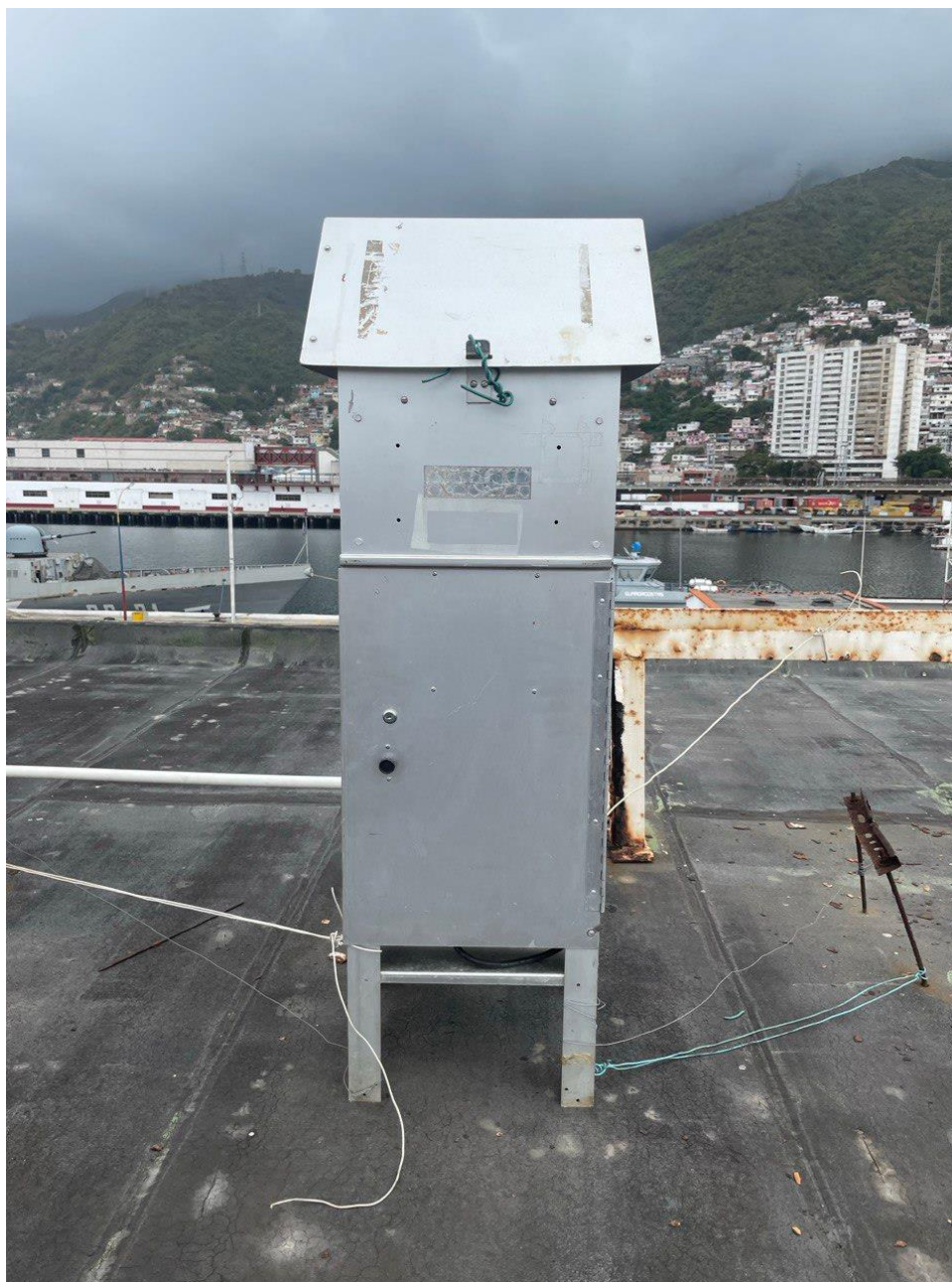
Figura 7: Muestreador de gran volumen, marca General Metal Works (GMW), Graseby.
