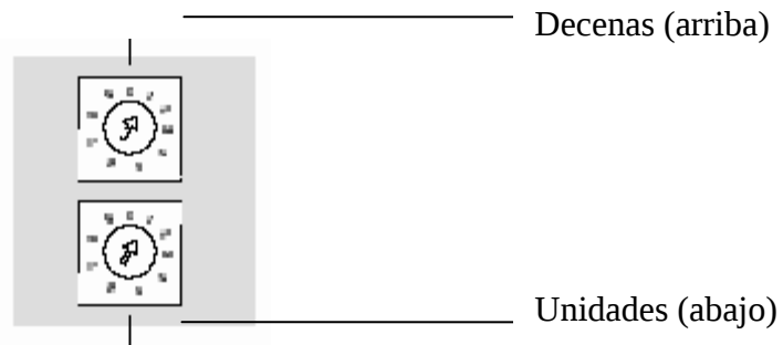
Figura 2.6.17 Switches rotatorios para fijar la dirección del Drop Remoto en la tarjeta CRA 93
