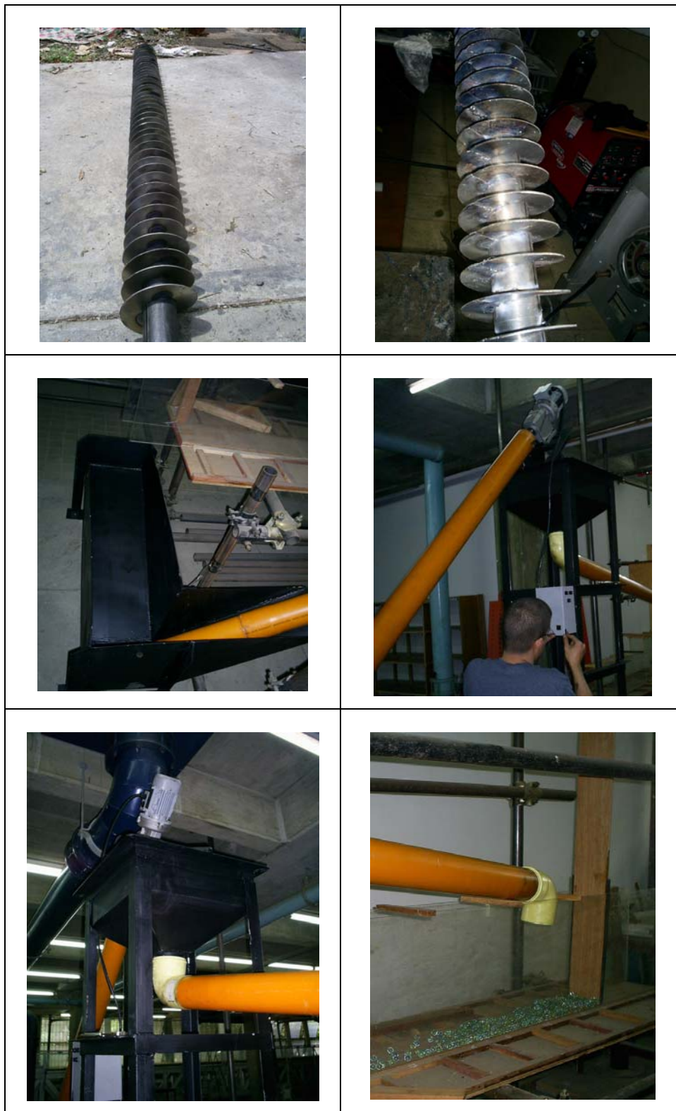
Figura 21. Distintas vistas del tornillo de transporte Ubicado en el Departamento de Hidráulica de la Facultad de Ingeniería UCV.
