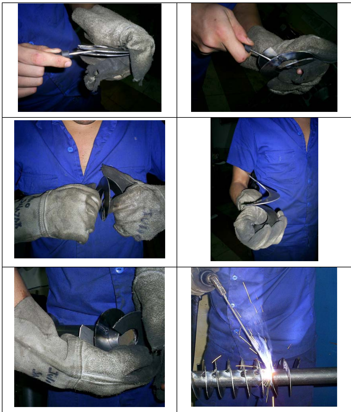
Figura 20. Pasos para el estirado y soldado de 2 arandelas unidas por soldadura para conformar 2 revoluciones de la hélice del Tornillo de Arquímedes.
