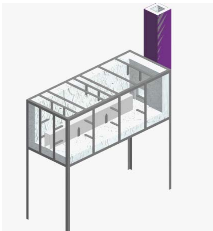
Fig. 16: Vista De La Fibra Del Horno
