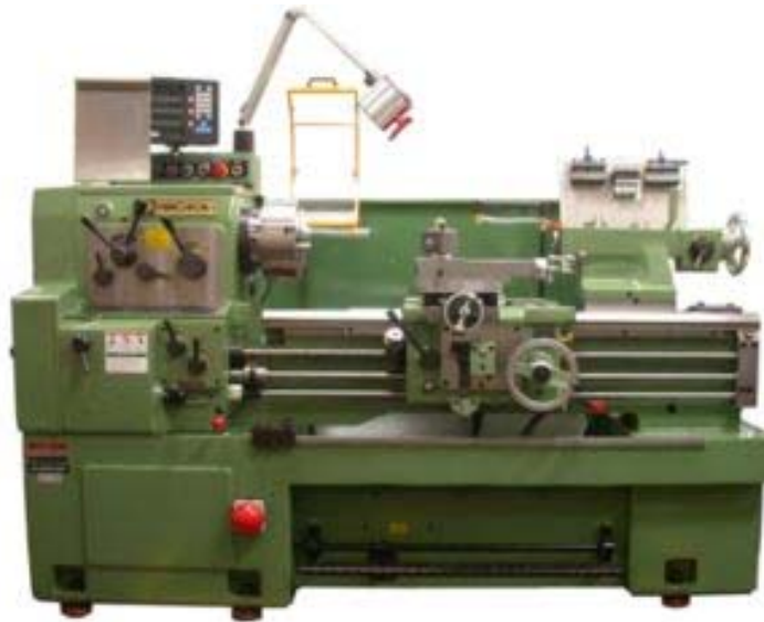
Fig. 1.16 Torno Convencional, usado comúnmente en el maquinado de piezas.
