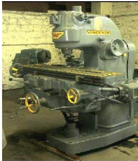
Fig. 1.18 Fresadora de tres grados de libertad, de uso común en talleres.
