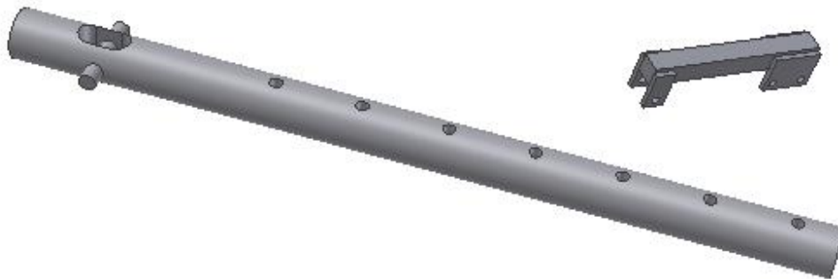
FIGURA 9: Diferencias geométricas de la palanca en los sistemas de aplicación de cargas del sistema original y el modificado. La imagen pone de manifiesto la reducción de tamaño.
