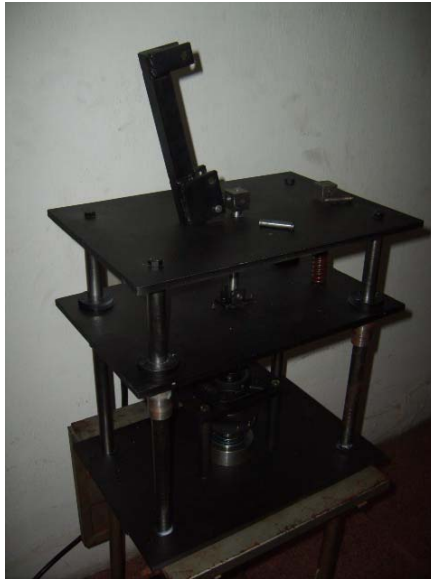
FIGURA 17: Máquina de fatiga con la palanca del sistema de aplicación de cargas en una posición que permite reemplazar las probetas. En esta imagen se pueden apreciar los pasadores que se removieron para poder mover la palanca.
