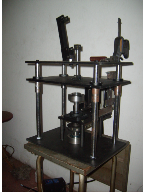
FIGURA 18: Máquina de ensayos lista para introducir las muestras en el porta probetas. Obsérvese el espacio libre sobre el porta probetas inferior.
