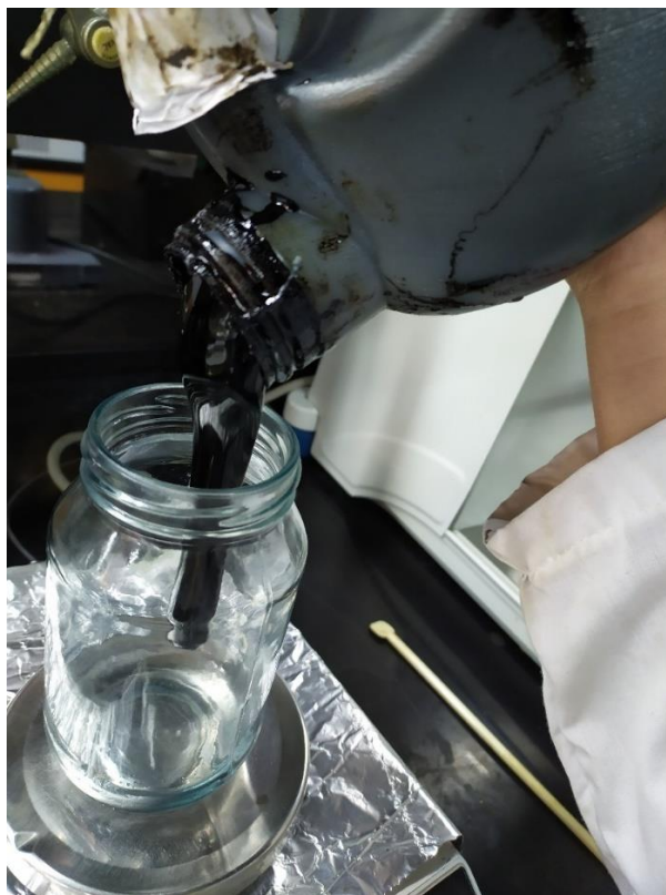
Figura N°14. Medición de muestras de crudo Bare para preparación de mezcla.
