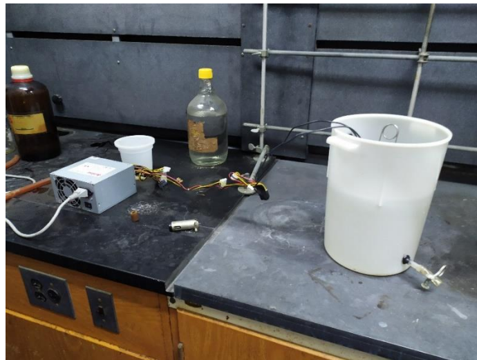
Figura N°18. Bomba calorimétrica sumergida en agua destilada durante proceso de combustión.
