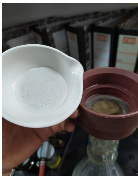
Figura N°20. Precipitado obtenido posterior a proceso de filtración.
