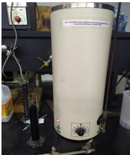
Figura N°16. Preparación de baño térmico para medición de gravedad API de mezclas @ 77°C.
