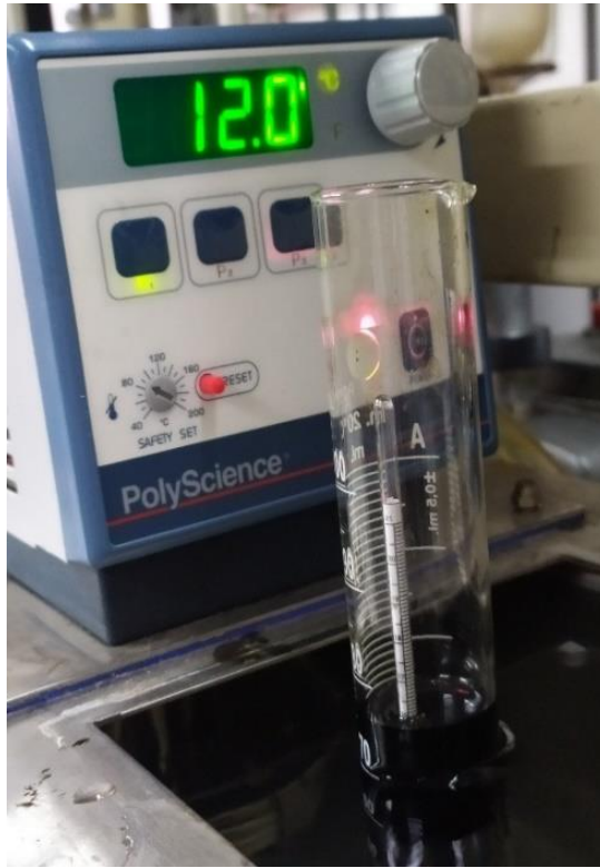
Figura N°15. Medición de gravedad API de mezcla Bare-GAN @ 12°C.
