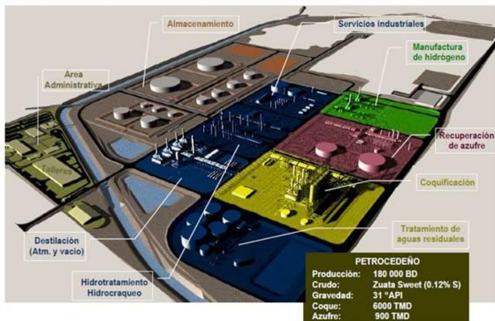
Figura N°5. Estructura del Mejorador de Crudo Petrocedeño.
