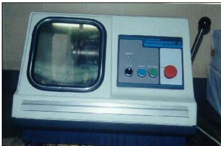
Figura 26. Sierra de esmeril BUEHLER Abrasimet 2
