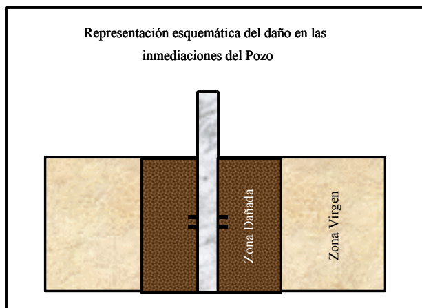
Figura 2.12 Representación esquemática del daño en las inmediaciones del pozo
