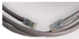
Figura 4.6. Patch Cord y Conectores
