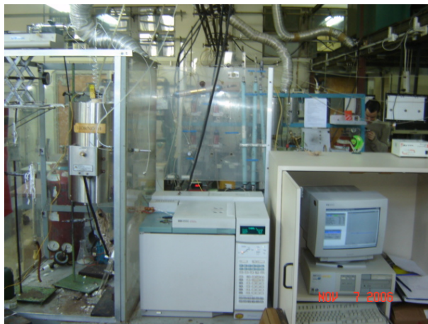
Figura N° 27. Equipo de reacción, análisis y procesamiento de datos dispuesto para la para de hidrogenación de tolueno
