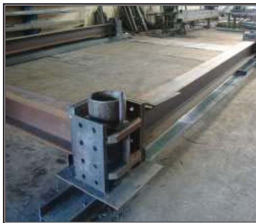
Foto No.4: Preparación de una Conexión para Columna Tubular Circular y vigas IPE de acuerdo a CIDECT No.9 Fuente: Fotografía de LOGES, S. (2008).
