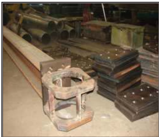
Foto No.4: Preparación de una Conexión para Columna Tubular Circular y vigas IPE de acuerdo a CIDECT No.9 Fuente: Fotografía de LOGES, S. (2008).
