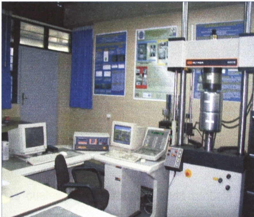
Fig. 2-3. Máquina INSTRON para ensayos de tracción.
