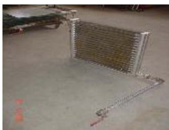
Figura 34. Intercambiador de calor
