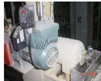
Figura 28. Sistema de dosificación de sémola
