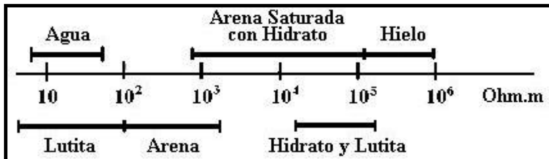
Figura 4.5. Rango de resistencia eléctrica de los hidratos, arena y lutita.
