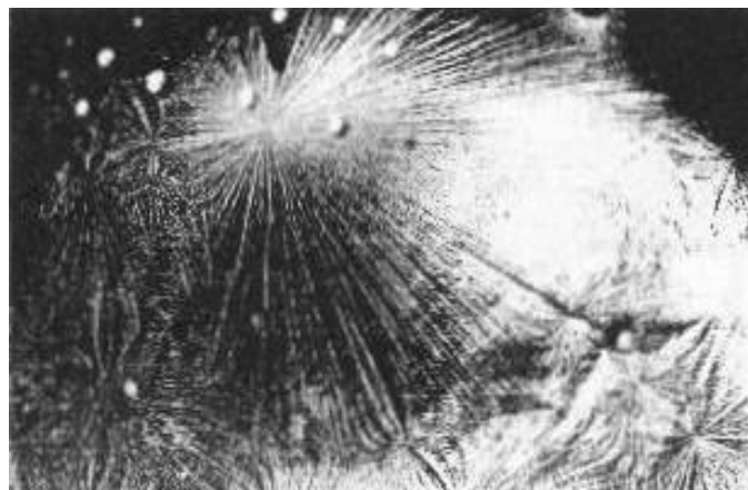
Figura 4.10. Capa de Hidrato de Metano (P = 811 Lpca; T = 42 °F).
