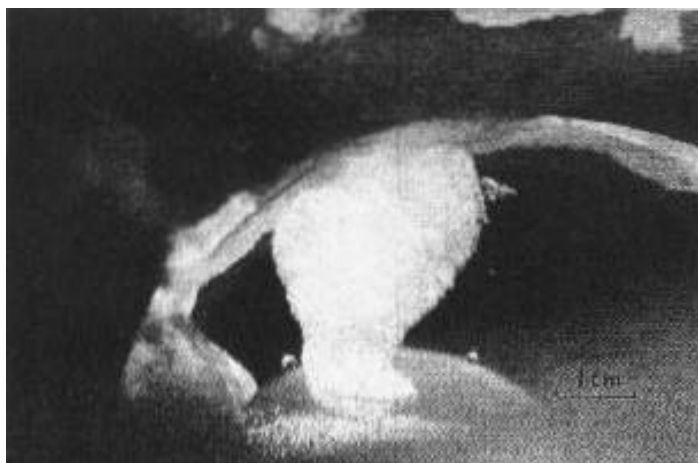
Figura 4.13. Hidrato masivo de Metano en un volumen de gas ( P = 870 Lpca; T = 36,2 °F).
