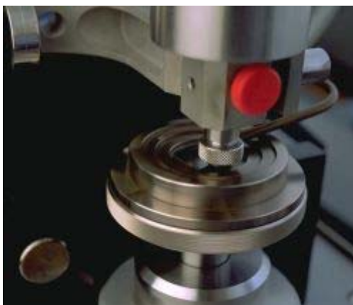
Fig. 2-6: Esquema de ensayo esfera sobre disco
