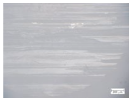
a) Ensayo SRV para V_s = -50 V y P_{dep} = 0,7 ; (2), (4) carga de 10 N y (3), (5) carga de 30 N
