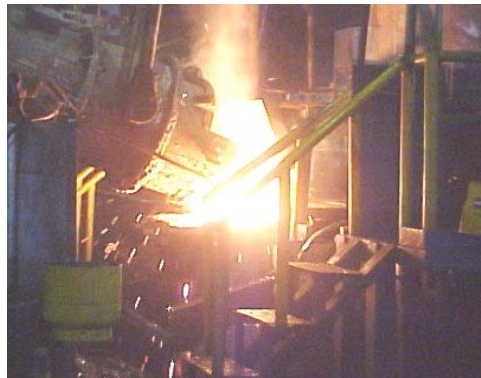
Figura 3.6 Transferencia del metal de la cuchara de reacción al colador
