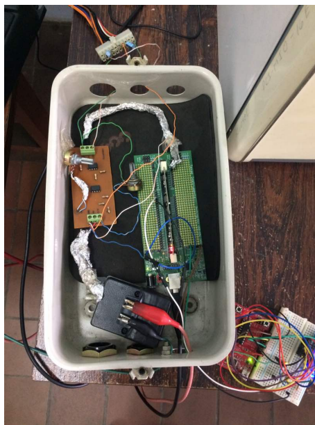
Figura 6.3. Medidor dentro de la carcasa, conformado por transformador reductor, circuito acondicionador y DSP.
