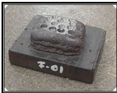
Fig 25. Probeta para Análisis Químicos
