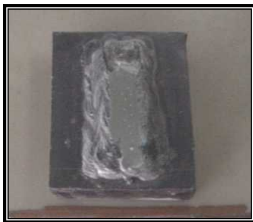
Fig. 26. Probeta para el Ensayo de Dureza.
