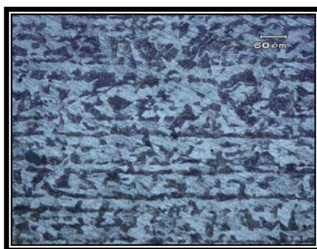
Fig. 21. Fotomicrografía del Metal Base (Acero A36).
