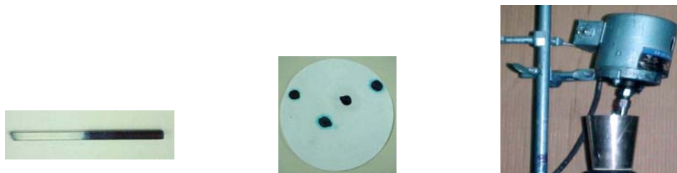
Figura 3. 9 Elemento s utilizados para formar la gota (Varilla, Filtro de Papel, motor agitador)
