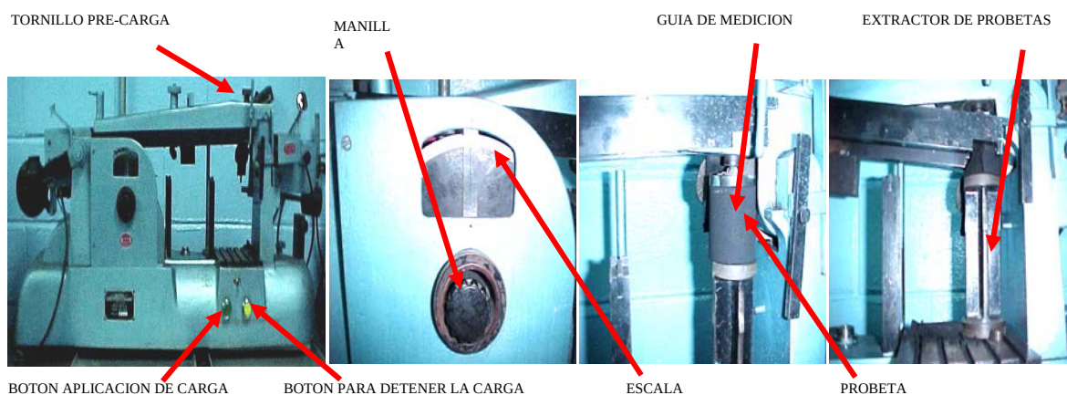
Figura 3. 4 Maquina de ensayo Universal marca Harry Dietert.
