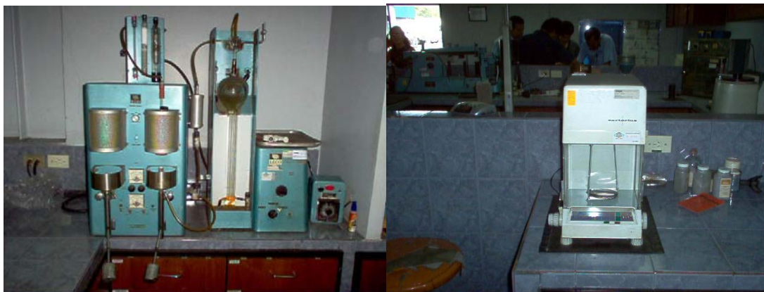
Figura 3. 11 Equipo utilizado para determinar el contenido de carbón en la arena de moldeo
