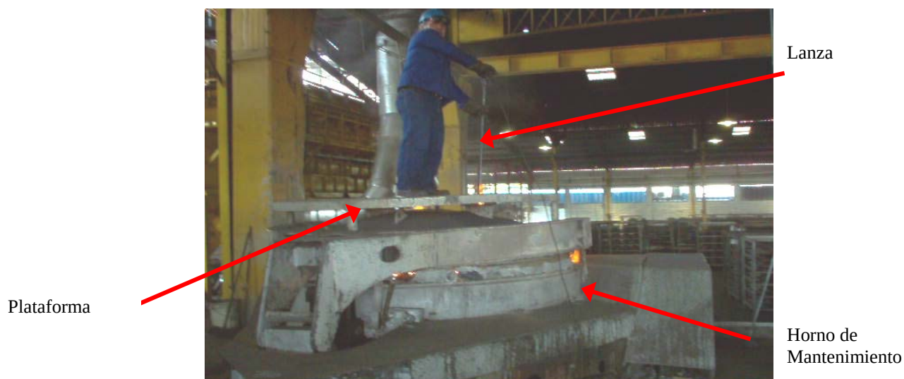
Figura 3. 14 Medición de temperatura en el horno de mantenimiento.
