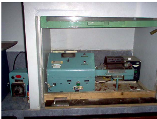
Figura 3. 13 Equipo para determinar la resistencia a la tracción en caliente de la arena shell
