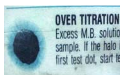
Figura 3. 10 Determnación de la aureola para determinar el contenido de bentonita en la arena de moldeo
