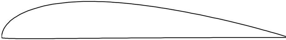
Figura 6.37. Perfil obtenido mediante NSGA-II: CAU, población inicial de perfiles de las series NACA 00-XX y de 5 dígitos, y p_m = 0,01
