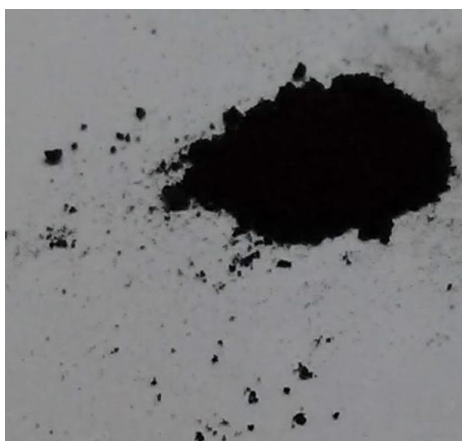
Figura 10: Asfaltenos obtenidos a partir de la separación SARA de un crudo [25]
