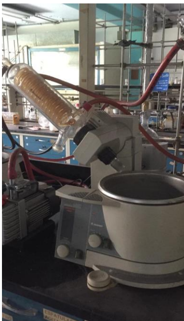
Figura 15: Imagen del Rotaevaporador utilizado para el fraccionamiento SARA, antes de colocar el balón de fondo redondo con el crudo y el solvente.
