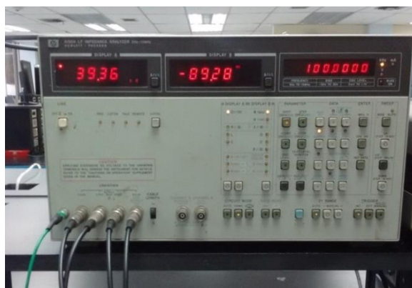
Figura 21: Analizador de impedancia HP 4192A LF Impedance Analyzer. Display A (Extremo izquierdo) módulo de la impedancia, display B (Centro) fase de la impedancia, último display (Extremo derecho) frecuencia.
