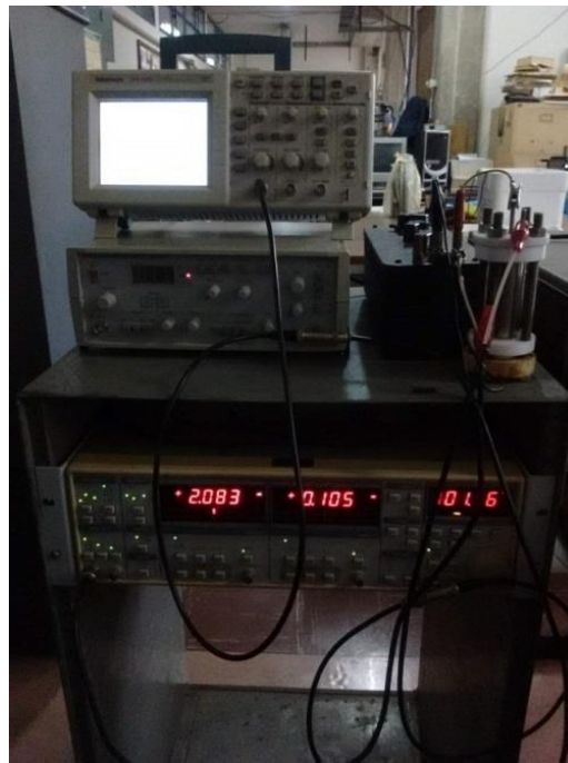
Figura 20: Disposición del Lock-In (Parte baja de la foto), Osciloscopio (Parte superior de la foto), Generador de ondas (Parte central de la foto, izquierda), condensador variable (Parte central de la foto, derecha) y celda de medición.
