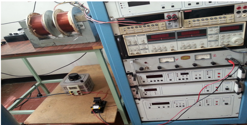
Figura 3.8. Montaje para la medición de magneto-resistencia
