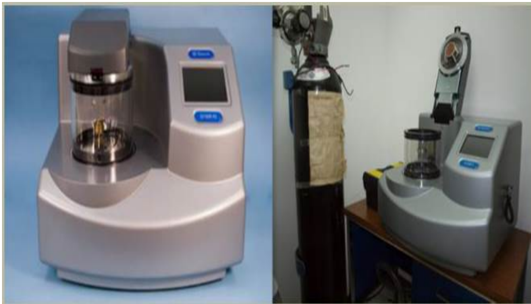
Figura 2.2. Pulverizador Catódico QUORUM Q150RS [3]
