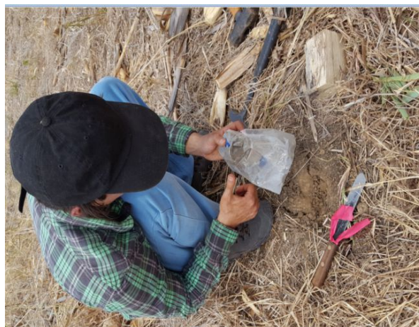
Figura 11. Toma de muestra individual en cilindro metálico para densidad aparente.
