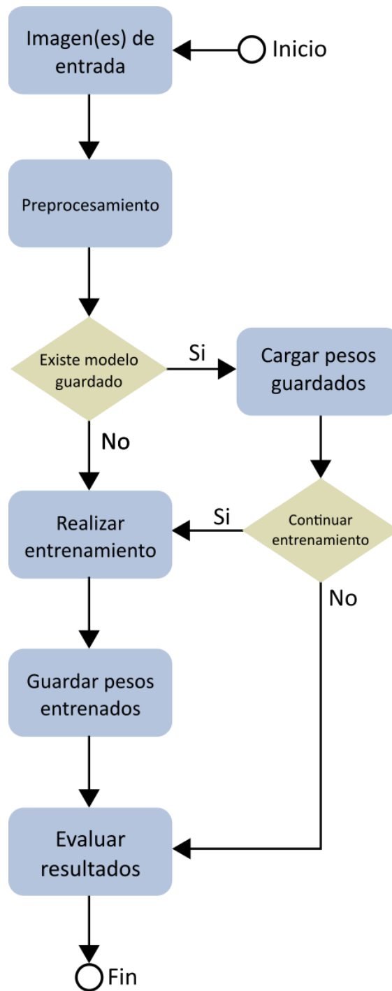
Figura 3.5 Diagrama de flujo de entrenamiento del modelo de redes de cápsulas.
