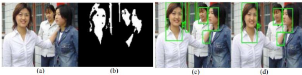
Figura 2.11 (a) Imagen original, (b) Imagen binaria entre color de piel (blanco) y fondo (negro), (c) Áreas marcadas con color de piel, (d) Imagen verificada usando proporción de alto y ancho [20].
