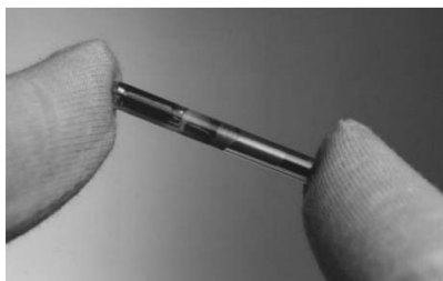
Figura 2.3.1.1.1: Transpondedor en capsula de vidrio
