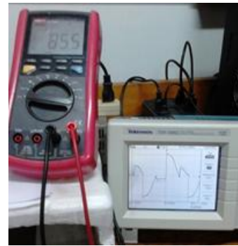
Fig. 67 Señal de voltaje de entrada al transformador de alto voltaje al variar la potencia de trabajo del horno de microondas: (a) 100 %, (b) 93,5 y (c) 76%.
