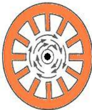
Fig. 18 Trayectoria de los electrones en presencia de campo magnético.
