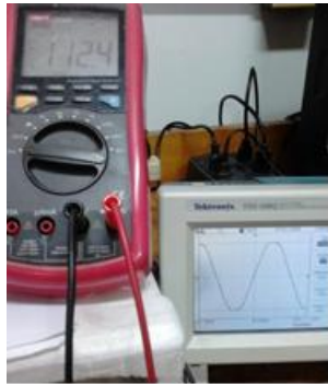
Fig. 67 Señal de voltaje de entrada al transformador de alto voltaje al variar la potencia de trabajo del horno de microondas: (a) 100 %, (b) 93,5 y (c) 76%.
