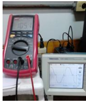
Fig. 67 Señal de voltaje de entrada al transformador de alto voltaje al variar la potencia de trabajo del horno de microondas: (a) 100 %, (b) 93,5 y (c) 76%.
