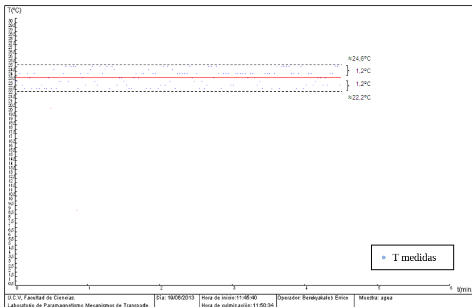
Fig. A3-1 Grafica de la temperatura versus el tiempo del agua sin control ON-OFF en lazo cerrado, duración 4 minutos y medios.
