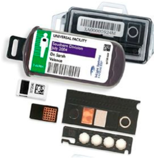
Figura 3.8: Dosímetros Luminiscente estimulado ópticamente
