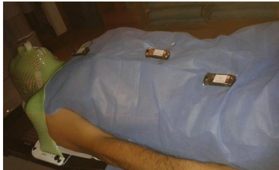
Figura 4.3: Montaje experimental. Dosímetros OSL a 20, 50 y 70 cm del isocentro de la lesión.
