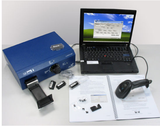
Figura 3.12: Sistema de dosimetría InLight™ de Landauer®
