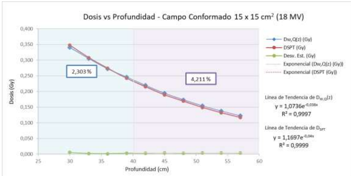
Figura 5.38.- Gráfica de dosis en función de la profundidad \geq 30 cm, con un campo conformado de tamaño 15 \times 15 cm 2 para un potencial de aceleración de 18 MV, utilizando la técnica de radioterapia 3D
