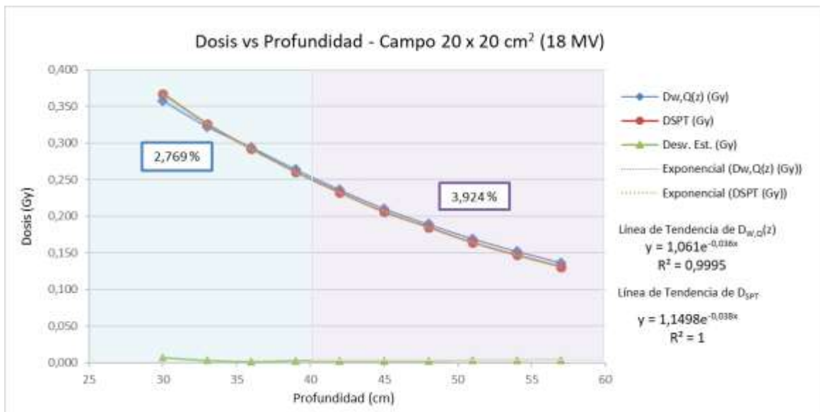
Figura 5.26.- Gráfica de dosis en función de la profundidad ≥ 30 cm, con un campo abierto de 20 × 20 cm 2 para un potencial de aceleración de 18 MV, utilizando la técnica de radioterapia 3D
