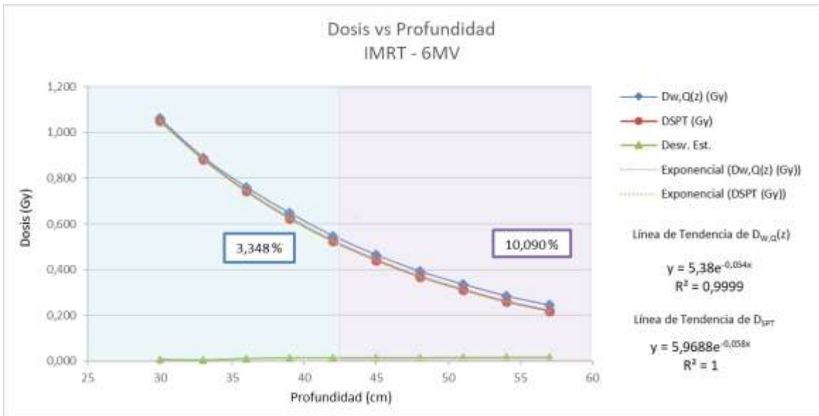
Figura 5.40.- Gráfica de dosis en función de la profundidad \geq 30 cm, con un campo abierto de 10 \times 10 \text{ cm}^2 para un potencial de aceleración de 6 MV, utilizando la técnica de IMRT
