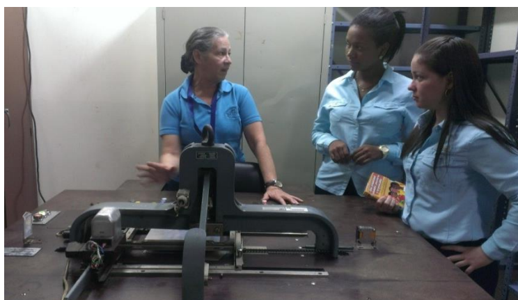
Máquina manual para la escritura punto por punto en braille en láminas de acero.
