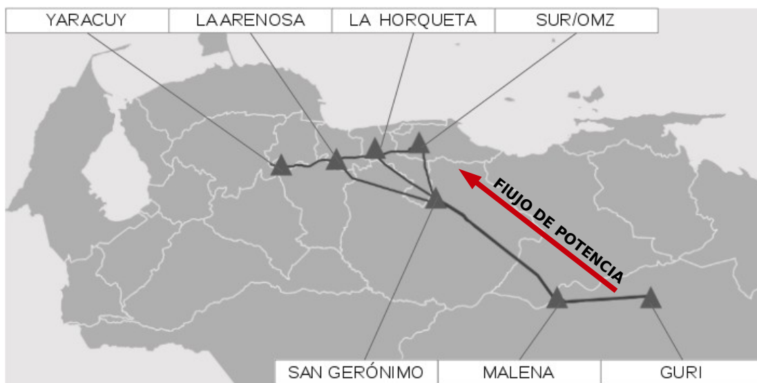
Figura 1: Mapa de Subestaciones a 765 kV
