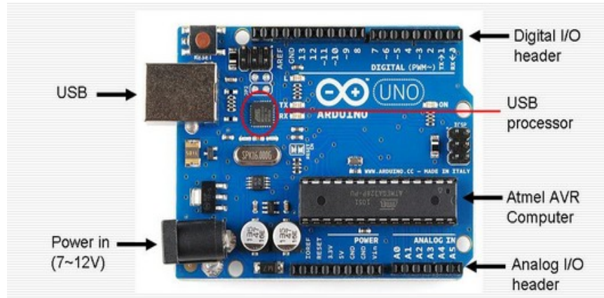
Figura 12: Componentes principales de la placa Arduino UNO R3
