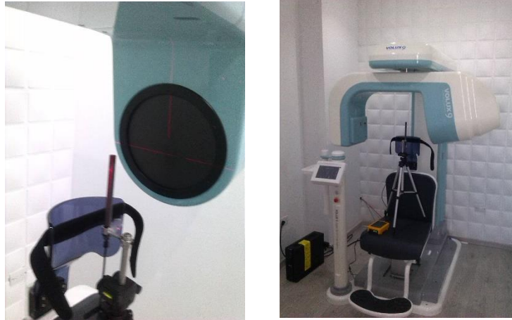
Ilustración 8 Montaje experimental empleado para la determinación del Kerma en Aire. Volux 9 ENT
