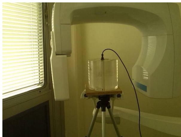
Ilustración 10 Montaje experimental para la determinación del índice de kerma en aire. Ambos maxilares.
