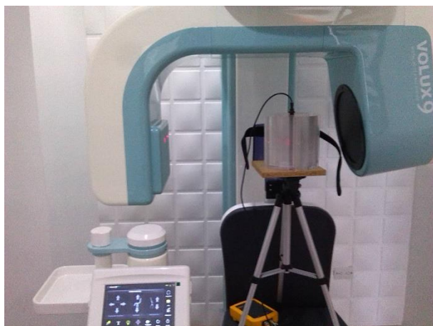
Ilustración 11 Montaje experimental para la determinación del índice del kerma en aire. Senos paranasales.
