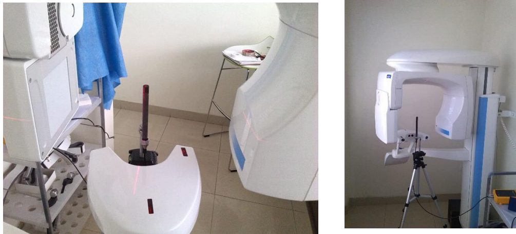
Ilustración 9 Montaje experimental empleado para la determinación del Kerma en Aire. Promax 3D
