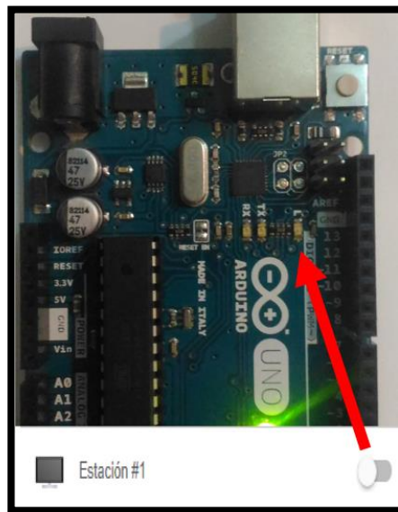
Figura 34: Estación #1 apagada y respuesta en el Arduino Uno
