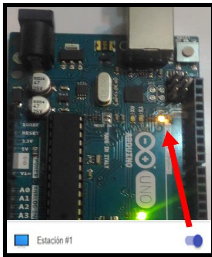
Figura 33: Estación #1 encendida y respuesta en el Arduino Uno
