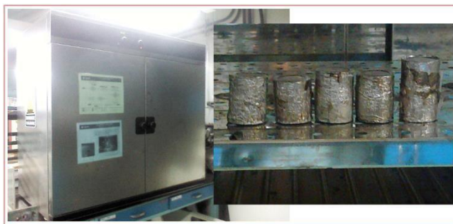
Figura 3.3 Horno para el secado de tapones en estudio.
