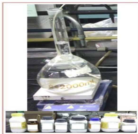
Figura 3.5. Preparación del agua de formación sintética con las sales correspondientes (Fuente propia).
