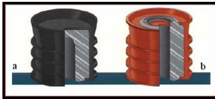
Figura 15 Tapones de Cementación. a) Tapón Superior. b) Tapón Inferior [8]
