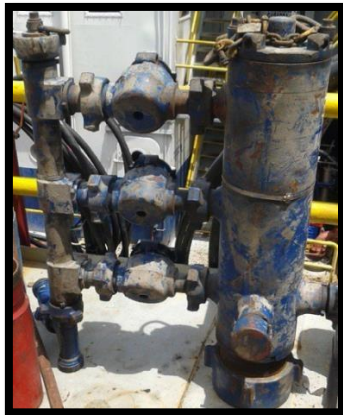
Figura 7 Cabezal de cementación 9-5/8 y 10.000 lpc [6]
