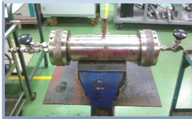
Figura 3. 12: Celda triaxial donde se empaco la muestra de tapón.
