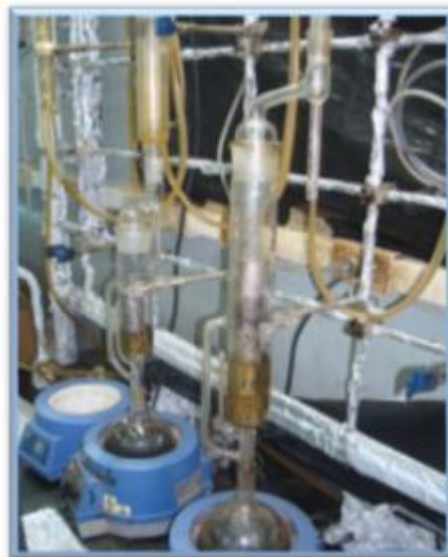
Figura 3. 3: Equipo dean-stark o soxhlet utilizado para la limpieza de muestras de roca (Licon, 2017).
