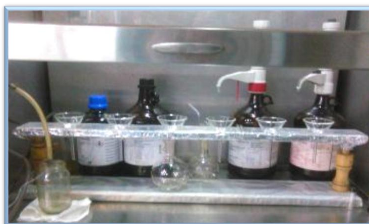
Figura 3. 23: Montaje para proceso de filtración por gravedad.
