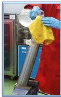
Figura 3. 14: Proceso de llenado del cilindro con agua de formación sintética.
