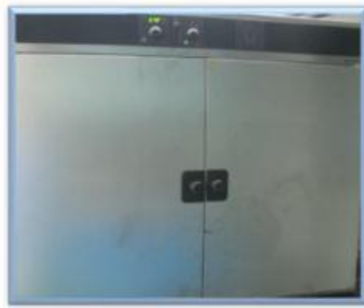
Figura 3. 4: Horno de secado de muestras Memmert UFP 800 (Licon, 2017).
