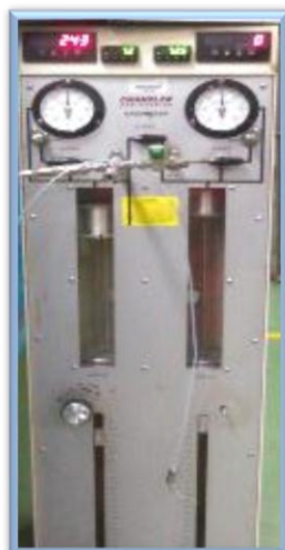
Figura 3. 7. Gasómetro ruska utilizado para contabilizar el gas.
