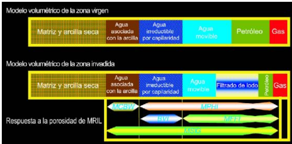
37Figura 2.37. Modelo de porosidad RMN para una formación humectada con agua. [3]
