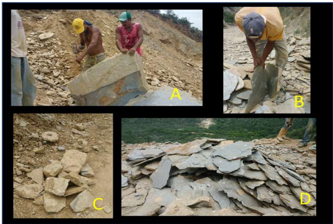
Figura 7: (A y B) Actividad de separación de lajas haciendo uso de martillo y cincel. (C) Muestra de piedra bruta, (D) Muestra de las lajas.
