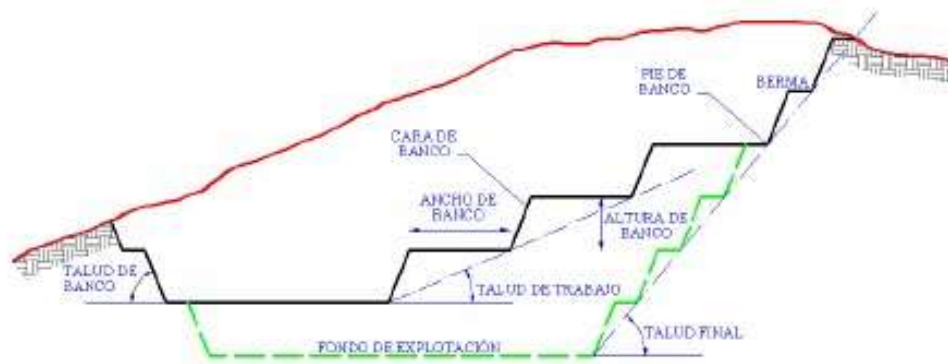
Figura 11: Terminología utilizada en minería a cielo abierto
