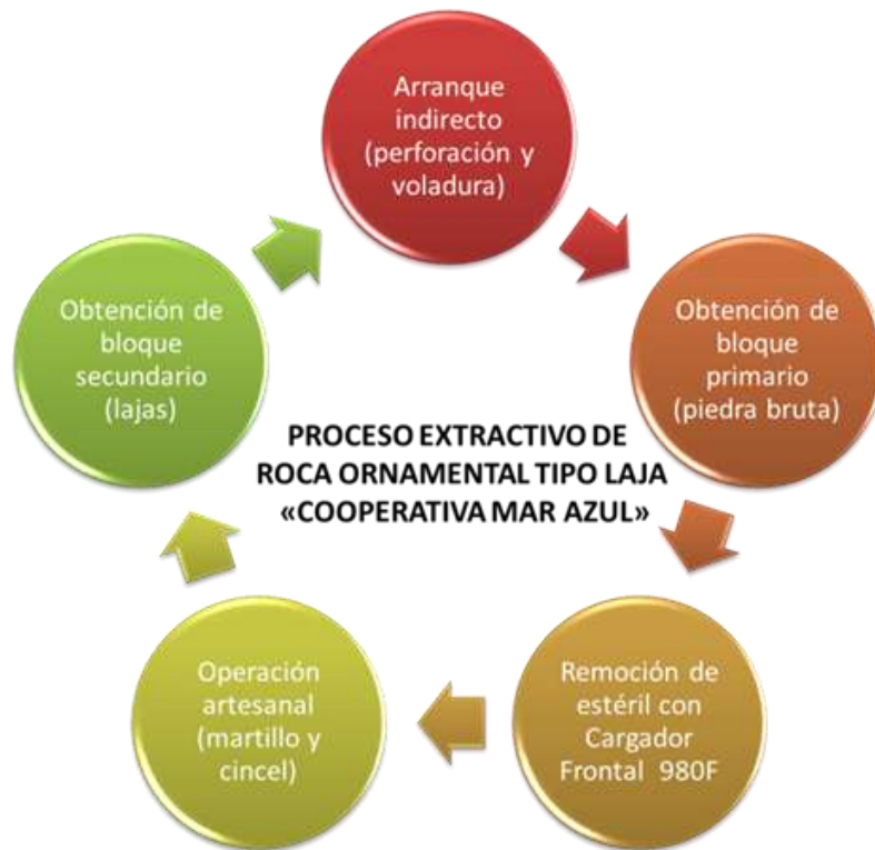
Figura 6: Proceso extractivo de roca ornamental tipo laja en Canteras Tacarigua
