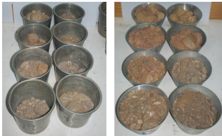
Figura 2. Muestras seleccionadas para realizar el ensayo de humedad natural.
