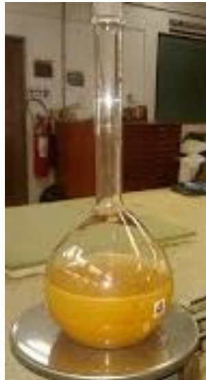
Figura 3. Picnómetro con la muestra de suelo para la determinación de la Densidad de los sólidos.
