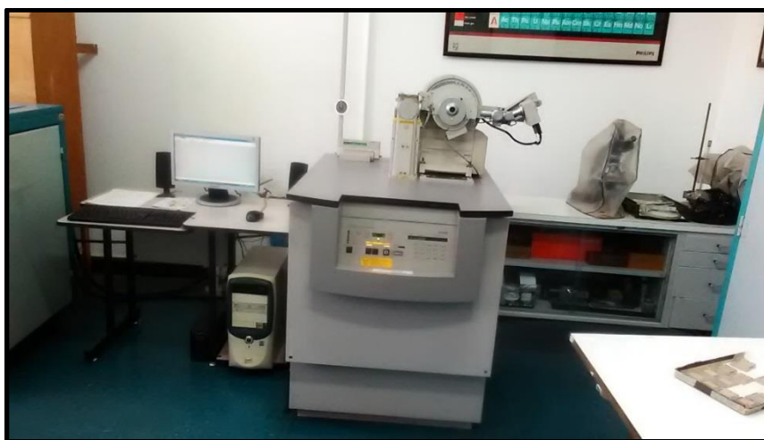
Figura 11. Equipo para la determinación cualitativa mineralógica por medio de la Difracción de Rayos X (DRX) de la Escuela de Geología, Minas y Geofísica de la UCV.
