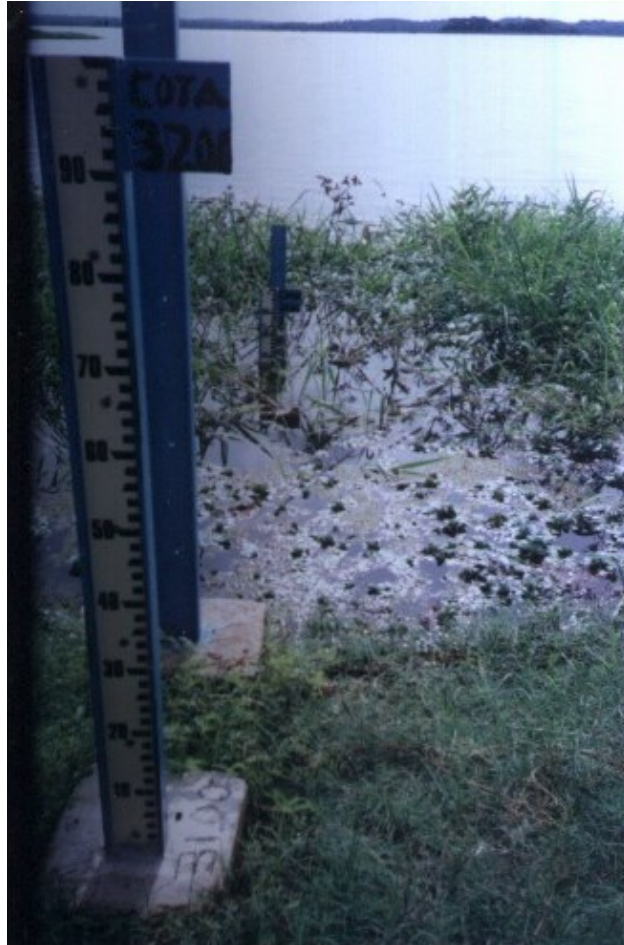
Foto 5.6. Miras en el embalse en buen estado y completas. Embalse “El Cují”.
