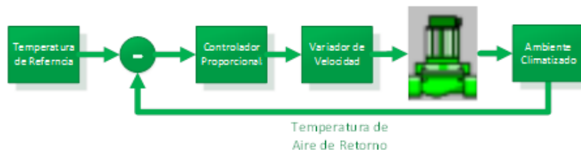
Figura 4. Diagrama de bloques de sistema de control de flujo de aire en UMAs.
