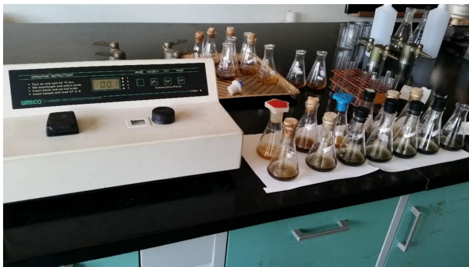
Figura 23. Técnica colorimétrica. Determinación de amonio mediante espectrofotometría de absorción UV-visible.
