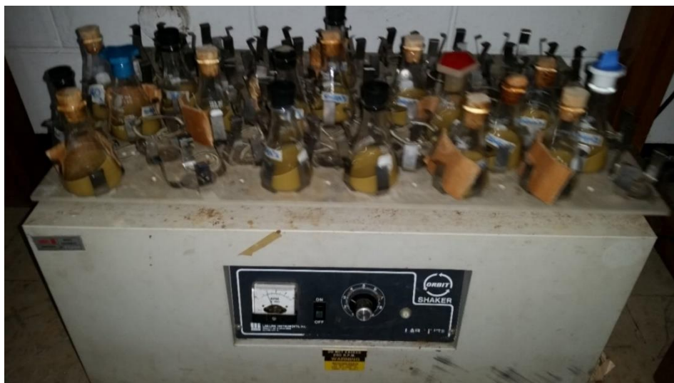
Figura 20. Agitación de muestras con Shaker para la determinación de la fijación de amonio mediante la extracción del amonio intercambiable.
