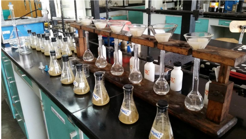
Figura 19. Filtrado de incubaciones de experimento de adiciones simultaneas para la extracción de potasio por el método de Acetato de amonio 1M pH=7.
