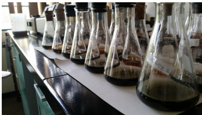
Figura 21. Desarrollo de color para la determinación de amonio mediante a método colorimétrico de azul de indofenol.
