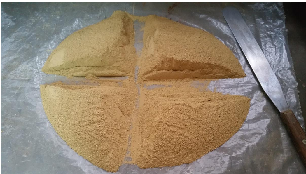
Figura 14. Separación de muestra homogeneizada en cuatro partes iguales para el cuarteo.
