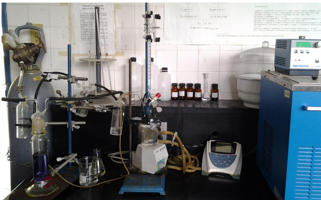
Figura 10. Equipo de medidas de fem(H) empleado.
