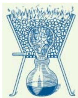
Figura 1. Representación esquemática del método indio para producir zinc. 2
