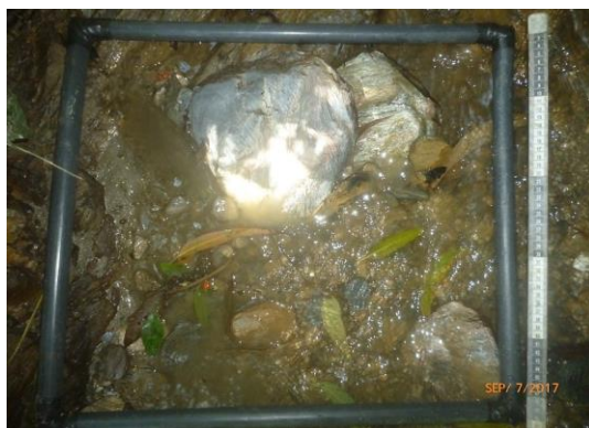
Figura 7. Cuadrata empleada para la caracterización del lecho de las quebradas
