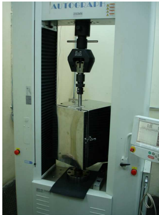
Fig.2.3.1.b. Máquina para Ensayos Mecánicos Shimadzu (AG-IS) y Cámara Criogénica
